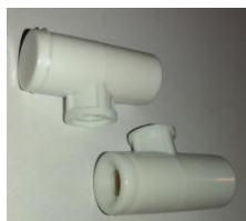
Фитинг "L"-образный (тупиковый) для подключения форсунки
